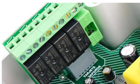
Zócalo para tarjeta de semáforos
