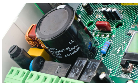
Salida de potencia y relés auxiliares, condensador de BUS y circuito de carga protegido
