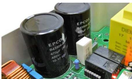
Condensateurs de Bus et circuit de charge protégé
