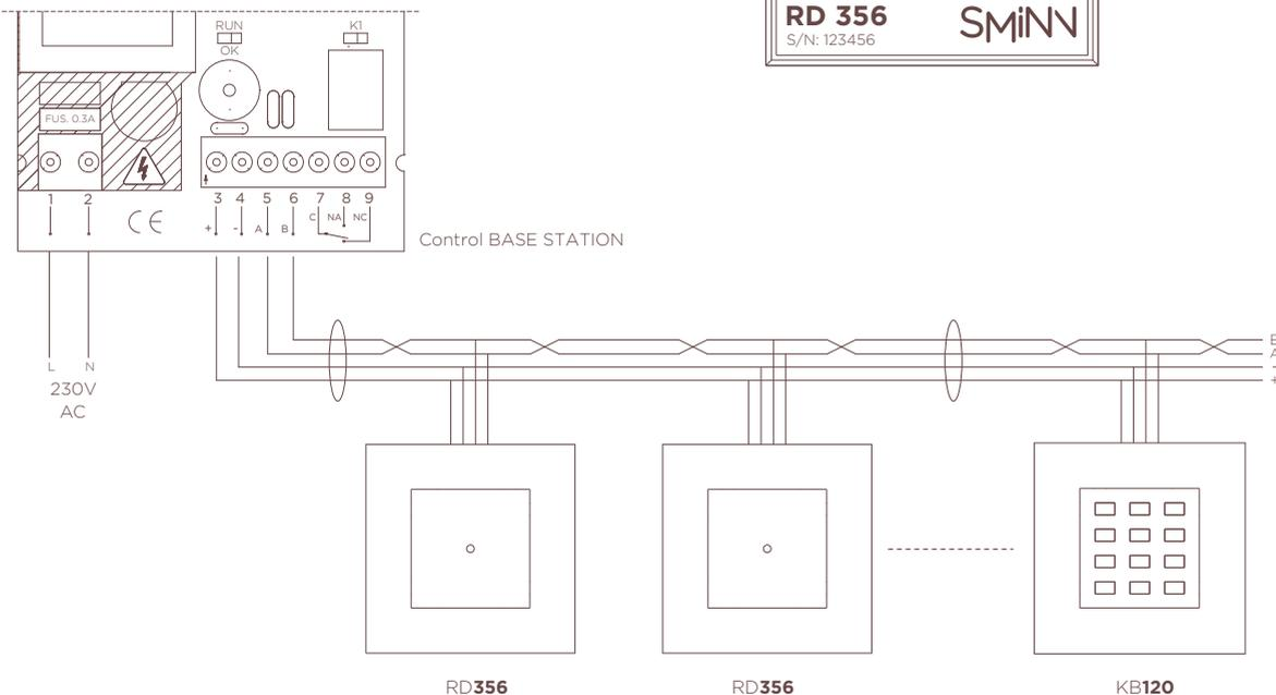
Fig. 1 Regleta de conexionado
